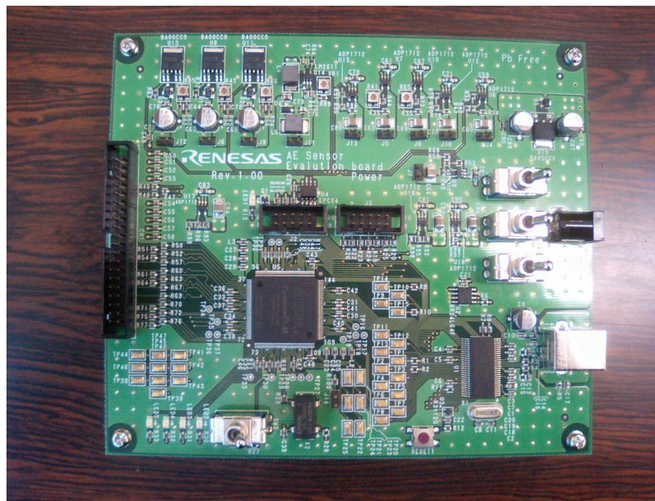
**CMOSセンサー評価用ボード基板
